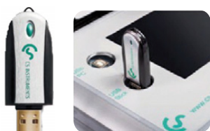
přenos dat z monitorovacích jednotek pomocí USB-disku
